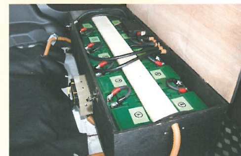
バッテリーは後部座席側。家庭用100V電源で充電できる（約8時間）。非常時には、逆に蓄電池として電源にできる。
