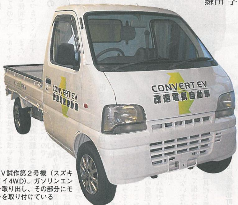
改造EV試作第2号機（スズキキャリイ4WD）。ガソリンエンジンを取り出し、その部分にモーターを取り付けている
