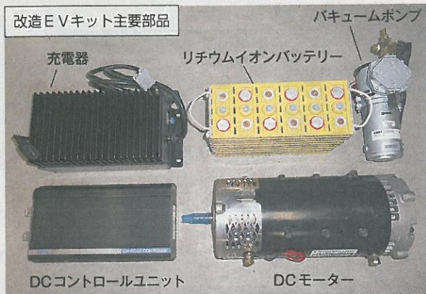
この他、DC／DCコンバーター（変圧器）や、モーターを取り付けるフレームなどがつく
